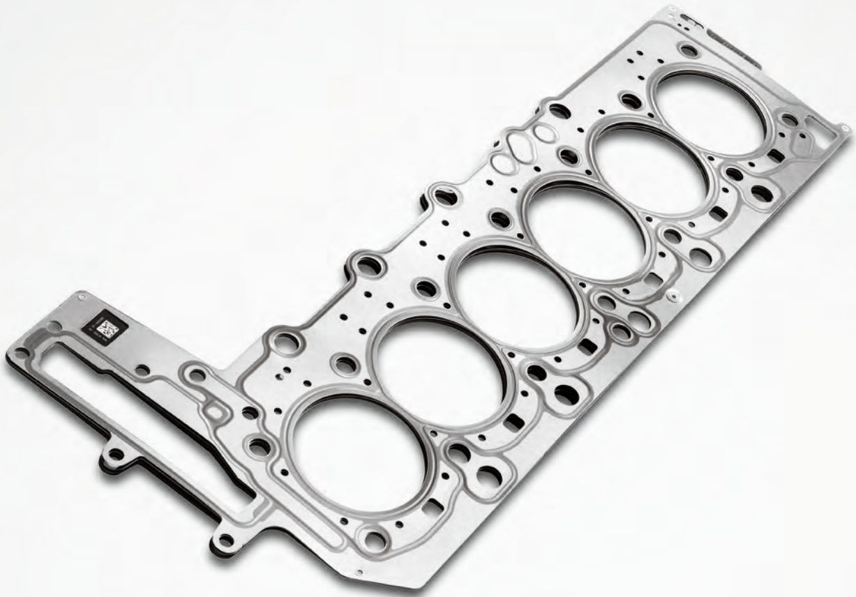
4,5-lagige Metaloflex™-Zylinderkopfdichtung mit partieller Beschichtung und Hinterland-Abstützung.
